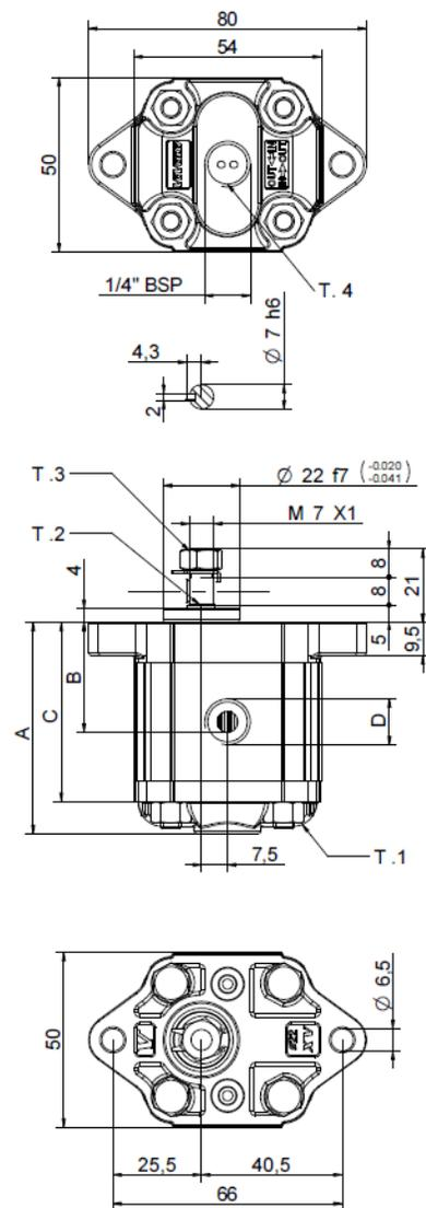
T.1 = 11.7±13.7 [Н-м] - крутящий момент затяжки винтов M6
